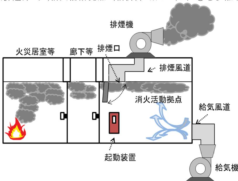
※ 消防の機械排煙は、基準上、排煙風道には排煙機、給気風道には給気機を共に設ける必要があるが、建築基準法上の機械排煙と基準が異なるため、建築基準法上の「押し排煙」を6.(2).①による基準により設置した場合は、令第32条を適用し、排煙用の風道に排煙機を設けないことができる。
